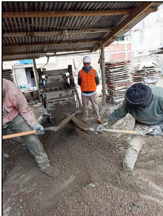
Con el propósito de efectuar el proceso de mezclado para la producción de bloques de concreto, se realiza en una forma manual o se utiliza la máquina mezcladora o también llamada hormigonera.
