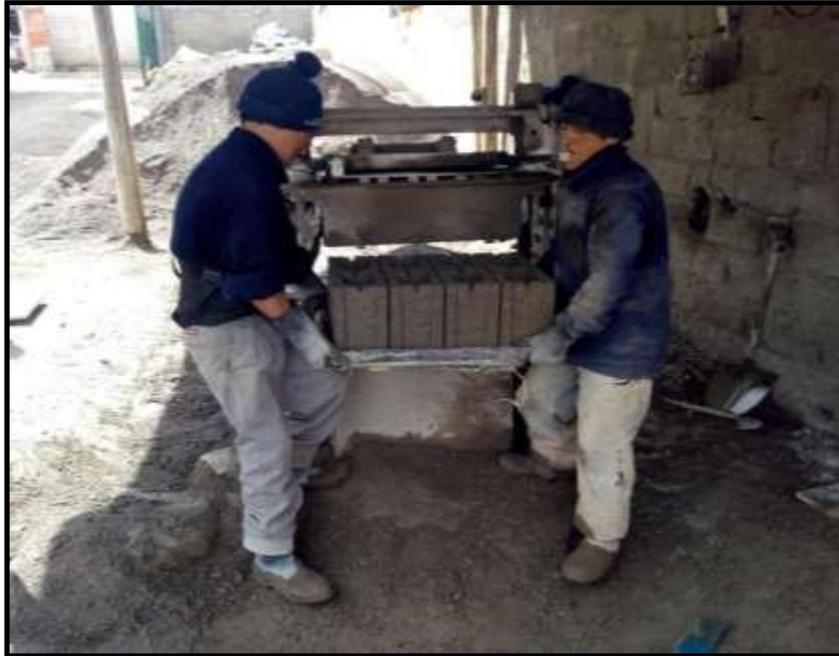
Durante el trabajo realizado diariamente, se utilizan 8 bolsas de cemento saliendo 56 bloquetas de concreto por bolsa de cemento, dando como resultado 448 bloquetas de concreto por día, luego éstas bloquetas de concreto se deja secar agregándole agua diariamente durante 7 días para que así pueda ser comercializado
