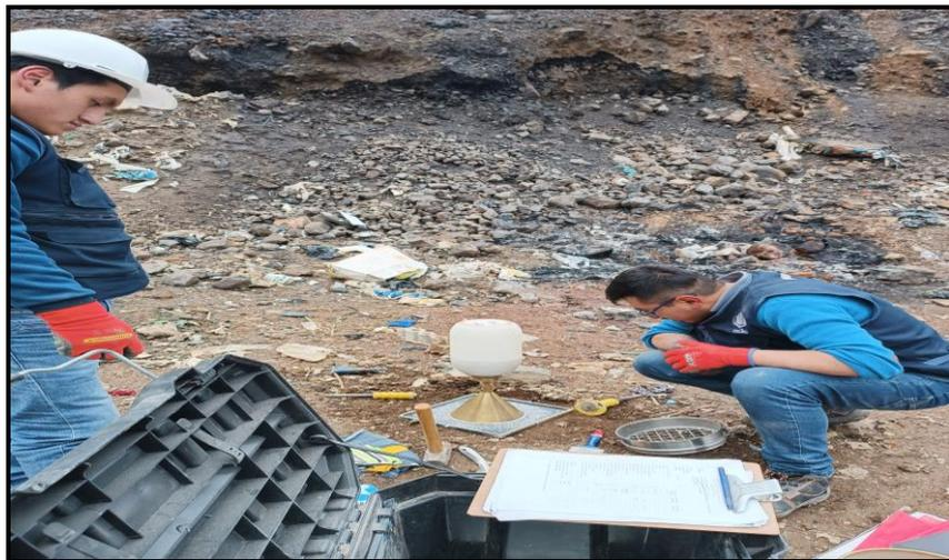
**Imagen N° 3: Trabajo de tomas de muestra mediante la técnica de cono de arenas**
