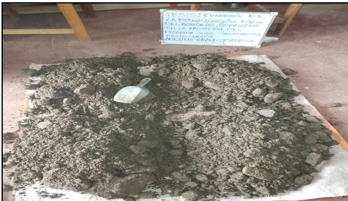
Imagen N° 10: Vista del proceso de análisis de granulometría
