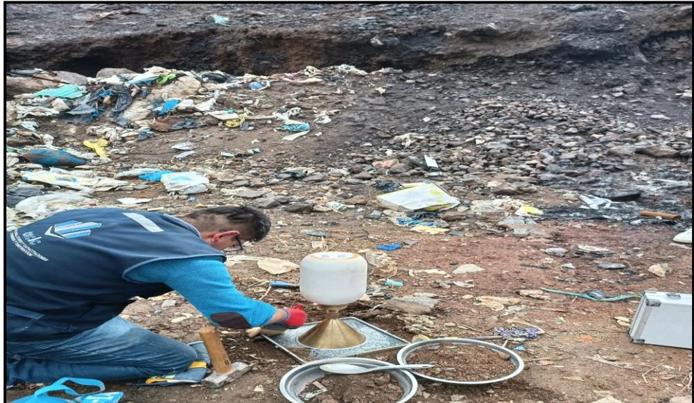
**Imagen N° 2: Trabajo de tomas de muestra mediante la técnica de cono de arenas de arenas**
