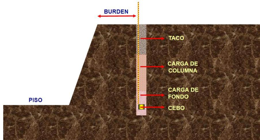
Figura N° 13. Carga de taladros en diferentes condiciones
