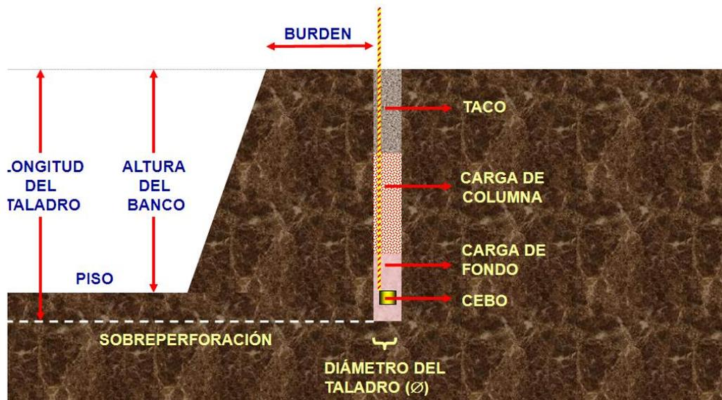
Figura N°3. Diseño de una voladura
