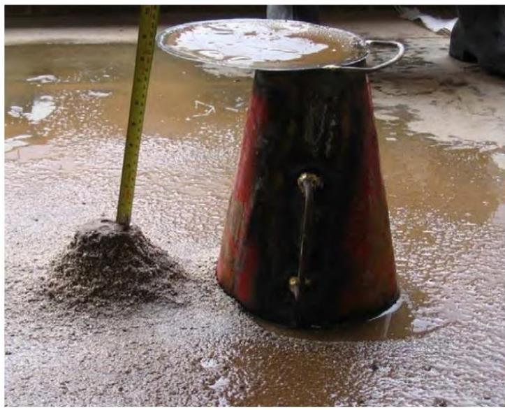
*Figura 22: Primera prueba de slump*
