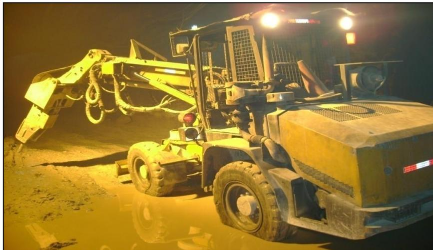
*Figura 18 - Equipo scaler PAUS, para desatado mecanizado*
