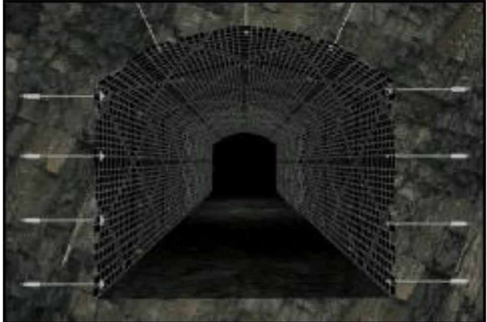
*Figura 15 - Distribución de pernos Hydraboltt*
