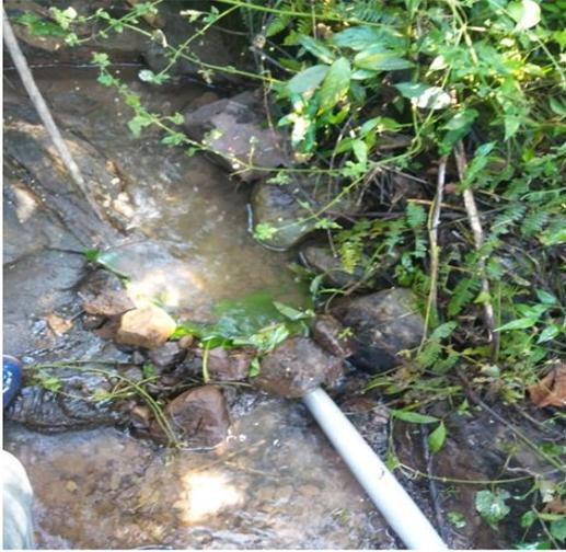
**FOTO N° 13:** Toma de muestra para determinación de la DBO y DQO
