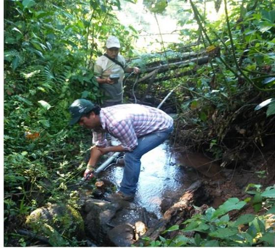
**FOTO N° 14:** Medición in situ de parámetros de campo de la fuente de agua utilizada para el proceso de beneficiado húmedo del café en el fundo Monte Rico.
