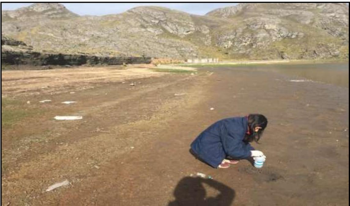
**Imagen. 8 Medición de Parámetros Físicos (pH, CE, OD) en Campo**
