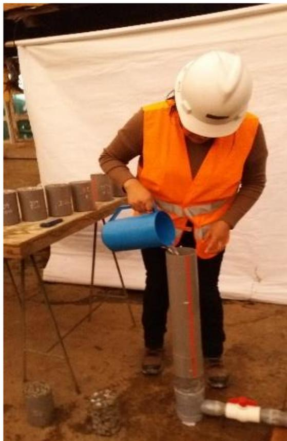
Ilustración 16: Ensayo de permeabilidad.
