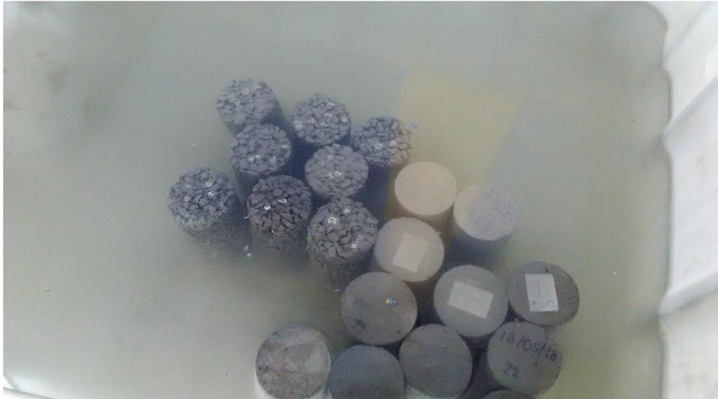
En la vista, se observa el respectivo curado que se realizo a las probetas de concreto permeable.
