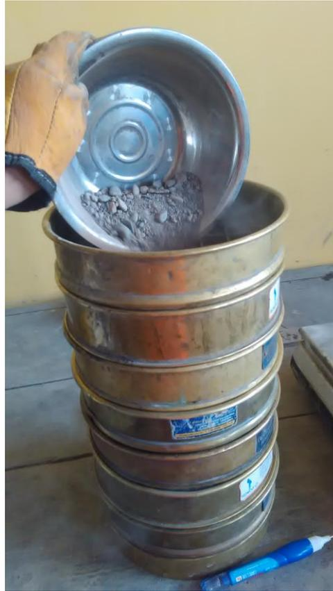
Ilustración 6: Tamizado del agregado fino.
