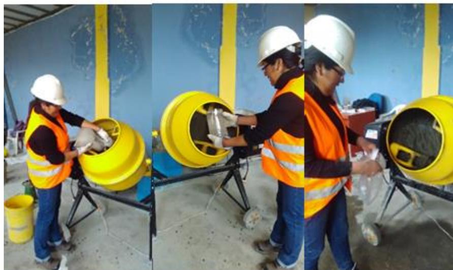
Ilustración 8: Procedimiento de mezclado del concreto permeable
