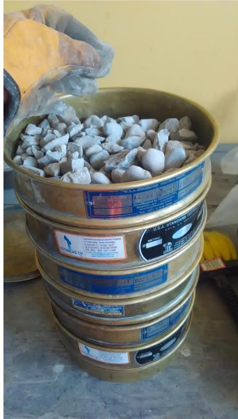
Ilustración 5: Tamizado del agregado grueso.
