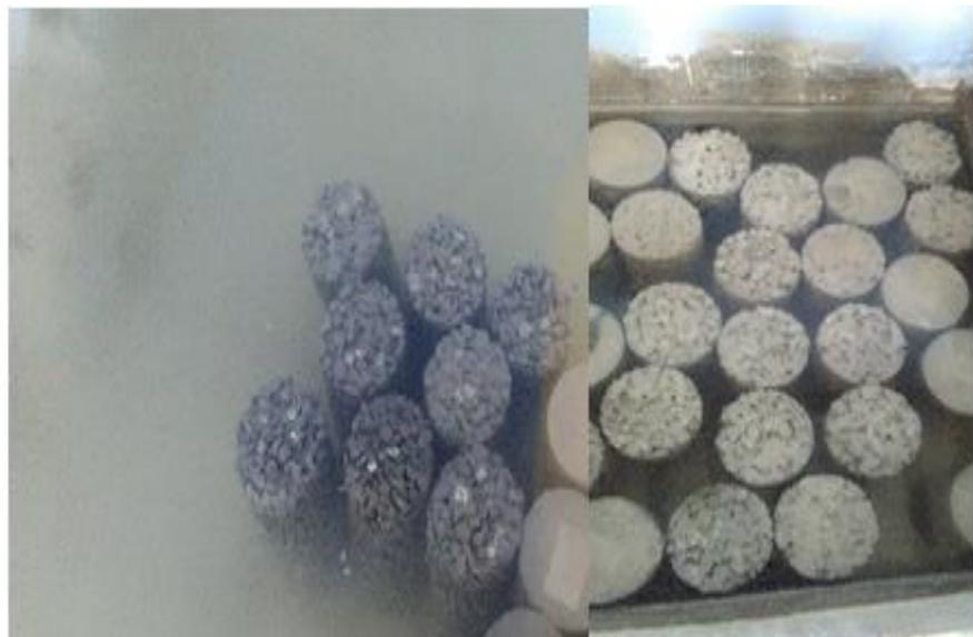
Ilustración 11: Curado en agua del concreto permeable.
