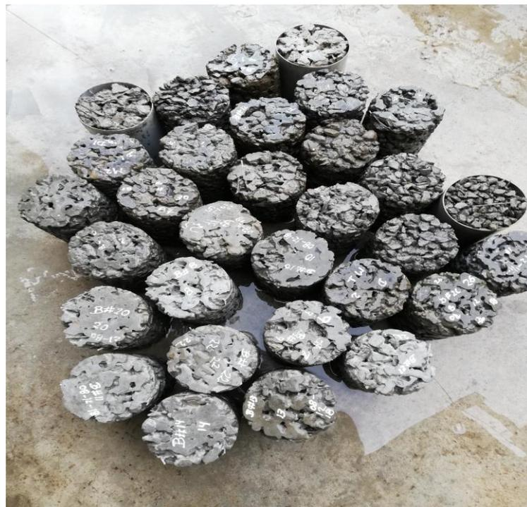
En la vista, se observa las probetas de 10 cm x 15 cm, para el ensayo de permeabilidad y contenido de vacíos.
