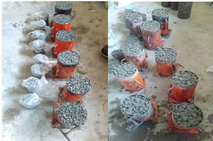
Ilustración 9: Elaboración de especímenes de concreto permeable
