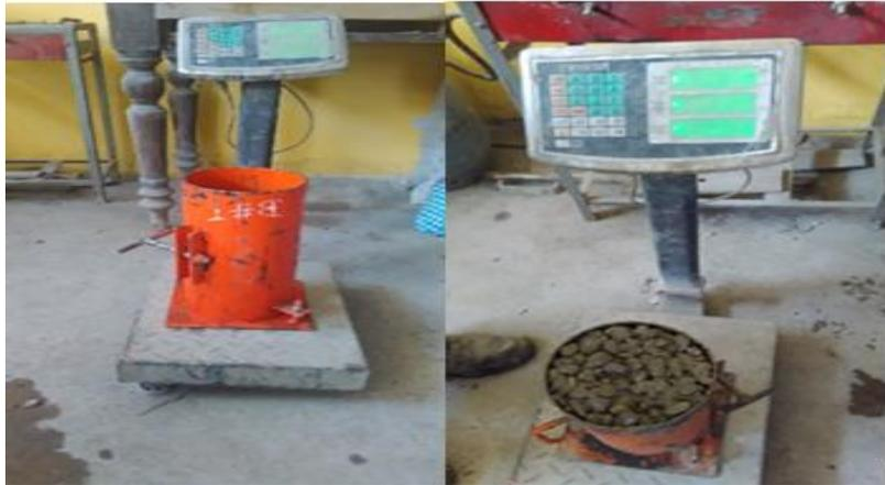
Ilustración 13: Ensayo de Peso Unitario.
