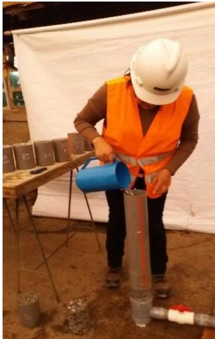
En la vista, realizando el ensayo para determinar el coeficiente de permeabilidad.
