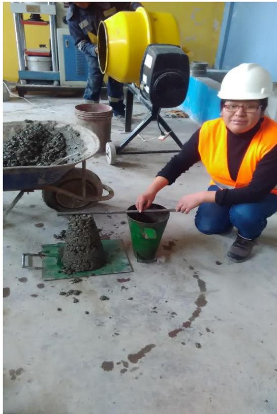
Ilustración 12: Procedimiento de ensayo del slump.
