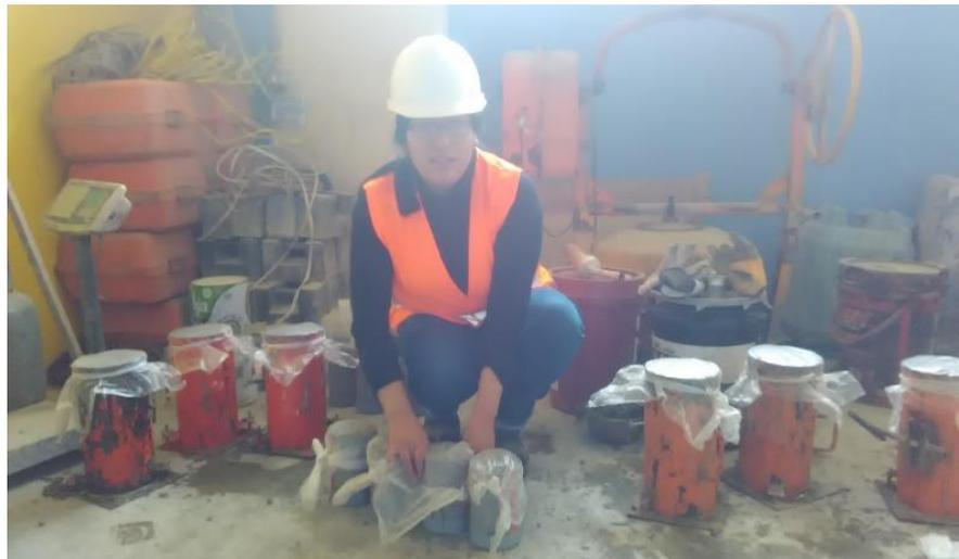
Ilustración 10: Curado y protección del concreto permeable.
