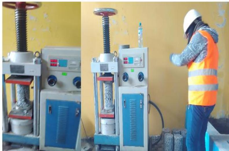
Ilustración 15: Determinación del ensayo a la compresión simple.
