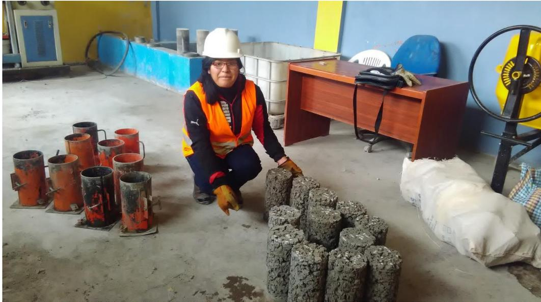
En la vista, se presentan las probetas cilíndricas de 6"x12", listas para ser curadas en la poza.
