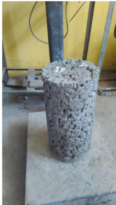
En la vista, concreto permeable en estado endurecido.
