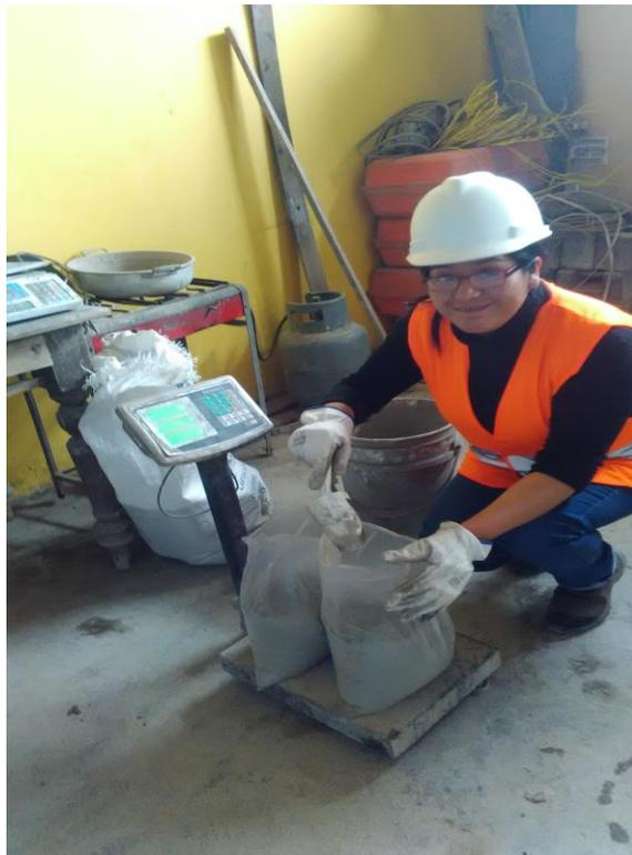
*En la vista, una vez diseñada la mezcla se procedió a pesar los materiales para la elaboración del concreto.*
