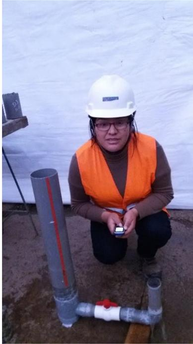
En la vista, realizando el ensayo de Permeabilidad, con el respectivo control del tiempo (cronometro).
