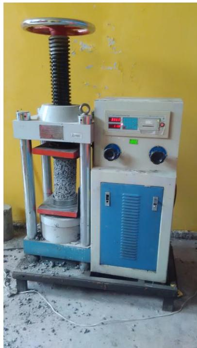
*En la vista, se desarrolla el ensayo de compresión axial de las probetas cilíndricas.*
