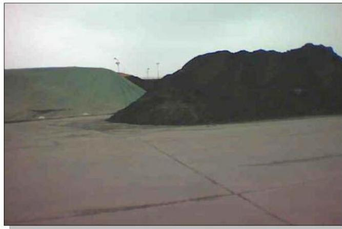
*Figura 9. Pila cerrada (mantead) y pila abierta (sin mantear).
