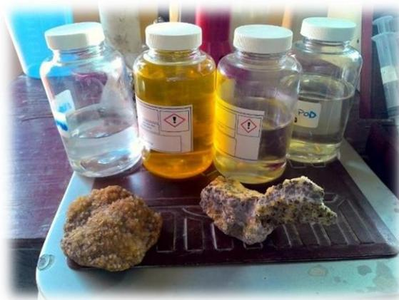
Figura 2. Colectores y espumantes
