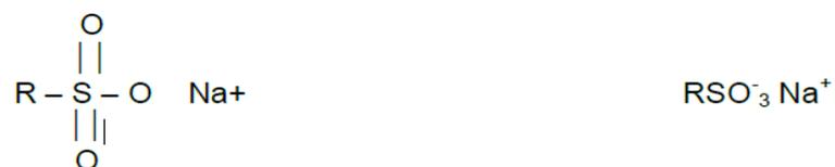
Se alimentan en el acondicionamiento o en el circuito de flotación. El efecto colector mejora con el largo de cadena, C14 – C17 da excelentes resultados. Se caracterizan por su propiedad
