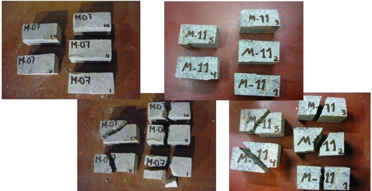
*Figura 4.5: Muestras del ensayo de carga puntual*
