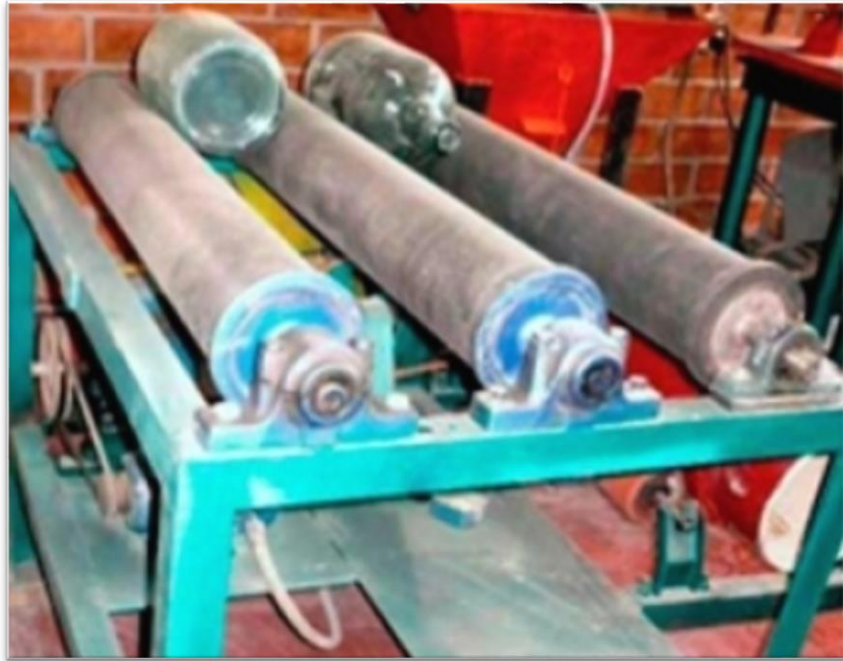
Gráfico 1: Lixiviación de mineral aurífero en botellas. Tomado de google
