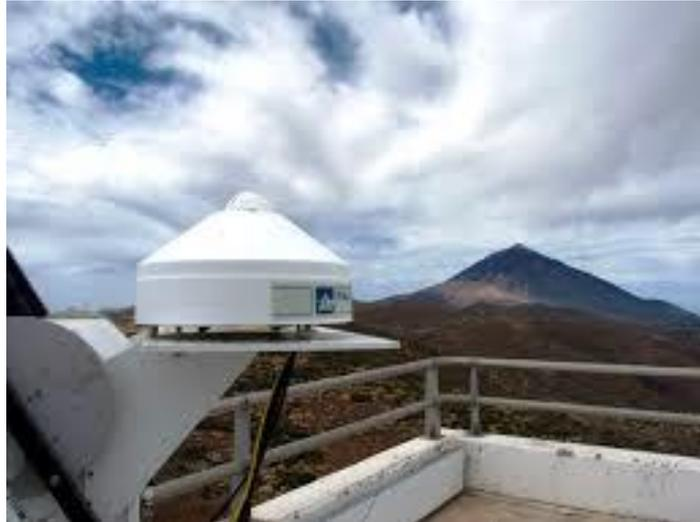
**Figura 9.** Piranómetro Kipp & Zonen. Atlas Energía Solar del Perú, 2003
