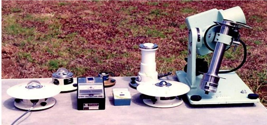
**Figura 8.** Instrumentos de medición de diferentes tipos de Radiación solar- Global, Directa y Ultra Violeta. Muñoz, 2005.
