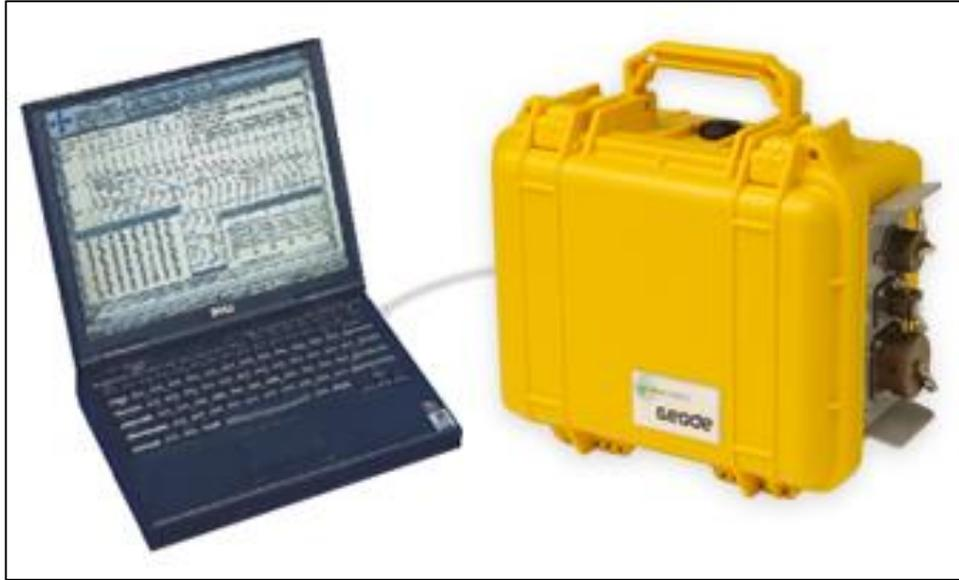
Sismógrafo de 24 canales, marca Geometrics, modelo GEODE
