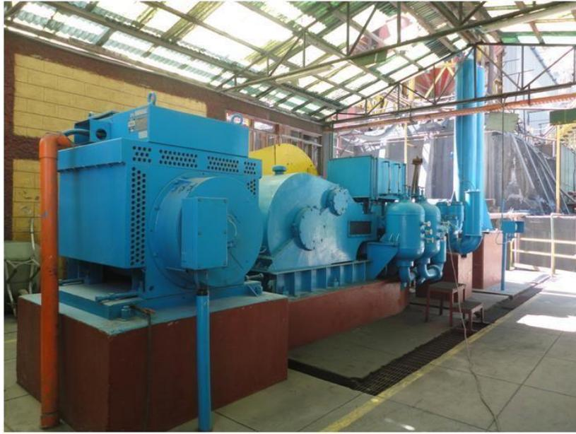
*Ilustración 9. Bomba Mars H-180 de 375 HP- 1100RPM*
