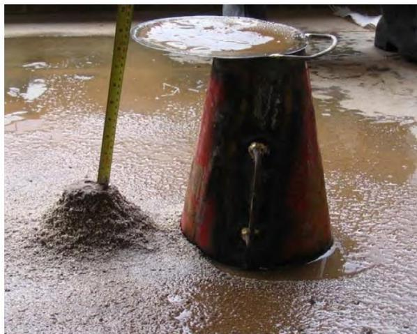
*Ilustración 6. PRIMERA PRUEBA DE SLUMP*
