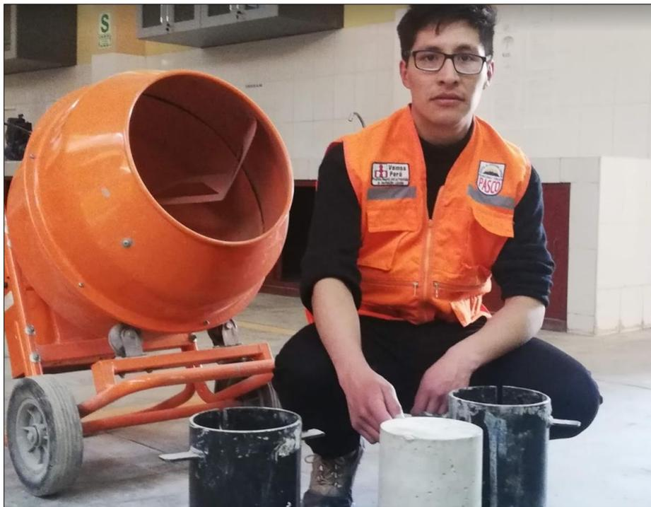
**Ilustración 7.** Molde cilíndrico – Mezcladora (trompito)
