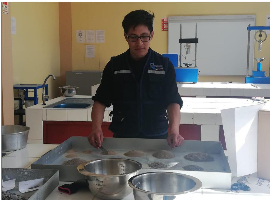
**FOTOGRAFIA N° 05: REALIZACION DEL CUARTEO DE AGREGADOS**
