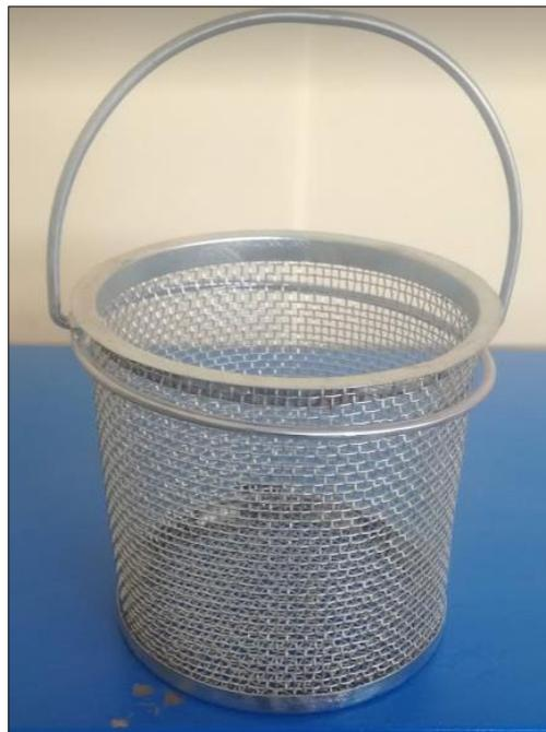
**Ilustración 23.** Cesta con malla de alambre con abertura correspondiente al tamiz N° 4
