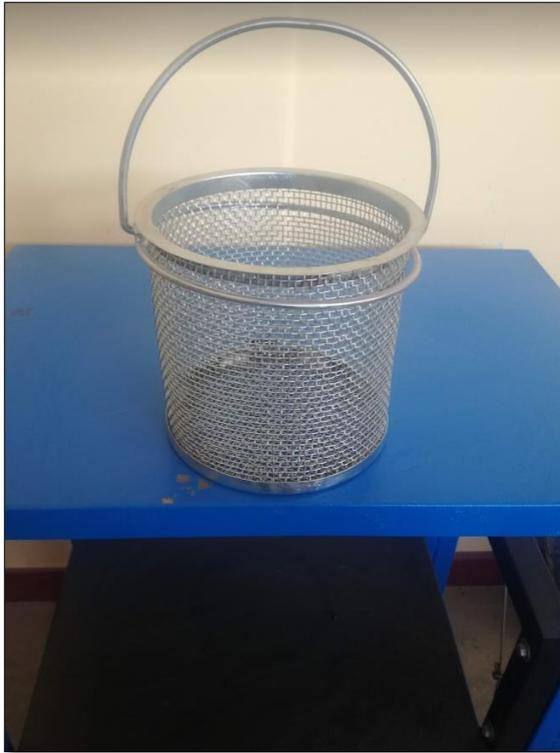
**Ilustración 20.** Equipo para peso específico
