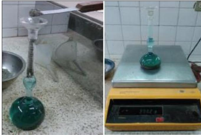
*Ilustración 7. Ensayo de Densidad Real del Cemento*
