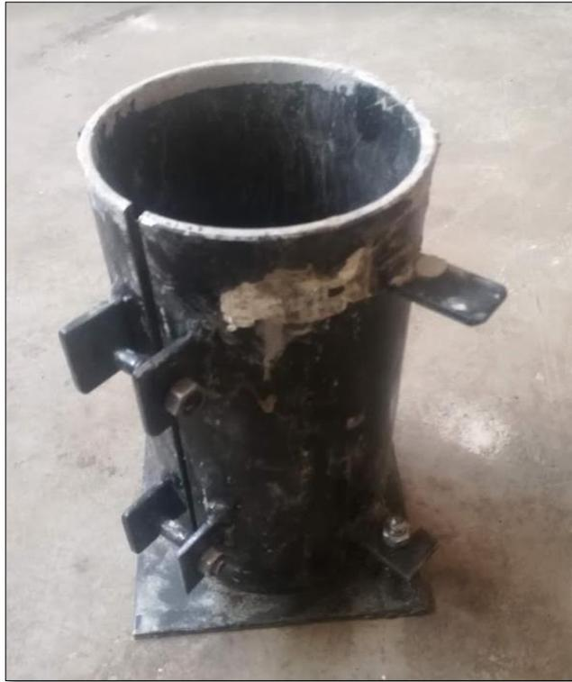
**Ilustración 18.** Molde cilíndrico
