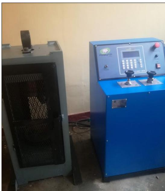
**Ilustración 25. Máquina compresora**
