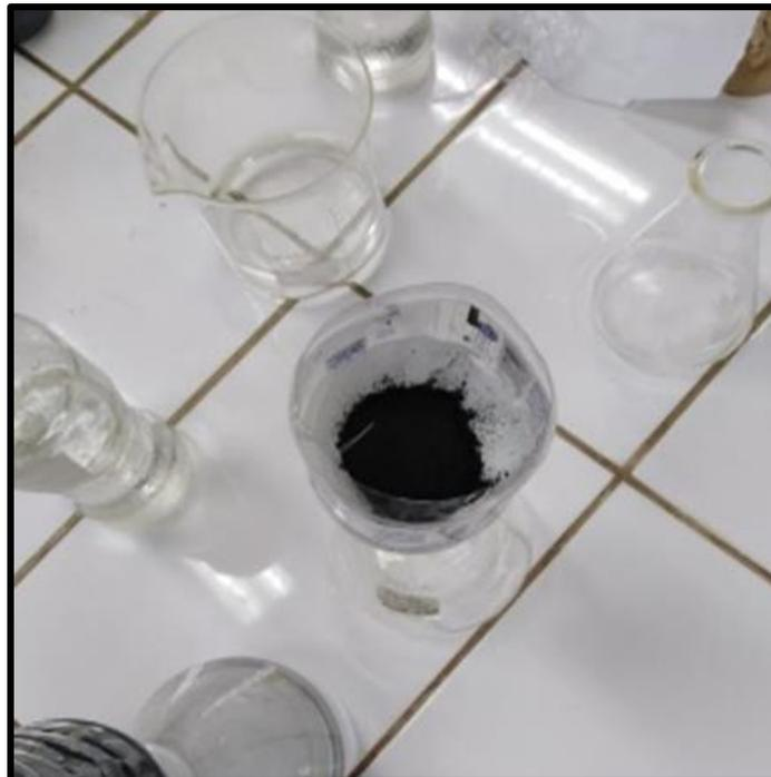
Foto 6: Aplicación de carbón activado de coco en 2 tiempos (10 gr de carbón activado de coco en 250ml de agua de consumo)
