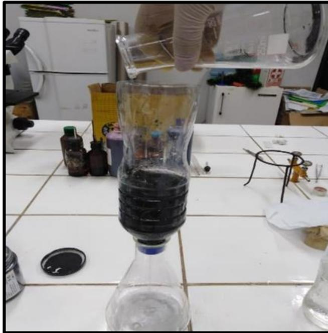
Foto 7: Aplicación del carbón activado de cáscara de coco en la muestra de agua a los tiempos designados 60 y 90 minutos, para luego ser analizados
