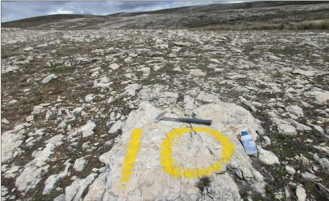
*Fotografía No 6. Afloramiento de extensos mantos fracturados de calizas y dolomías con calcita.*
