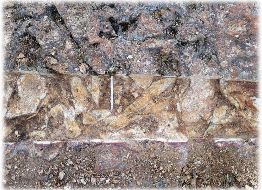
**Foto N°3.** Brecha Gioconda con coordenadas UTM: 224442 E, 8920569 N. clastos de toba andesítica de 5 a 10cm alterada con matriz de turmalina y óxido de hierro (limonita, hematita), pirita y drusas de cuarzo.
