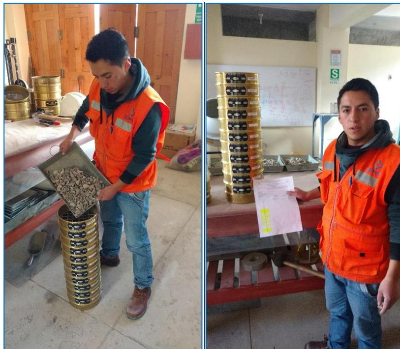
*En la vista, se realiza el ensayo de granulometría del Agregado Grueso*
