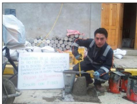
**Figura 21.** Determinación del Asentamiento del Concreto fresco.
