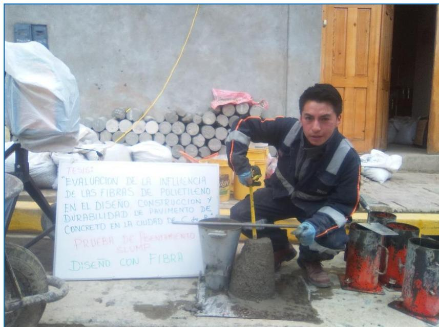
*En la vista, se realiza el ensayo de Cono de Abrams o asentamiento (slump) Siguiendo el procedimiento adecuado.*
