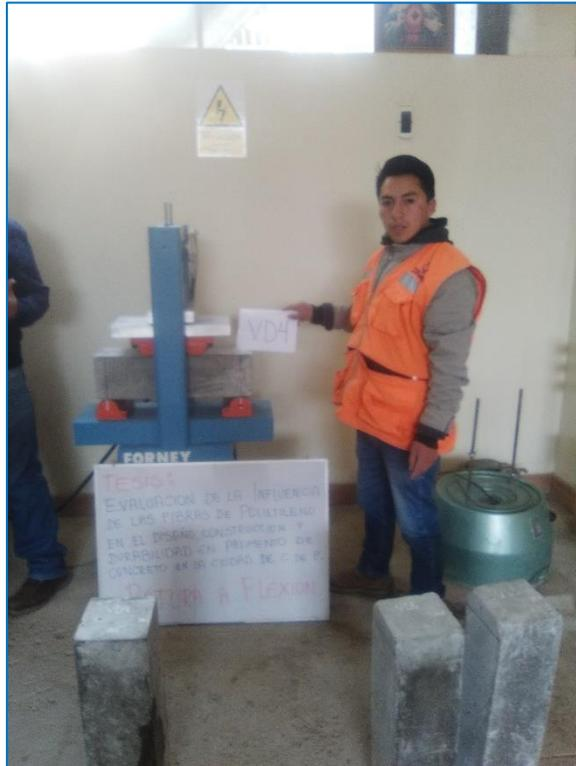
*En la vista, se desarrolla el ensayo de flexión en vigas de hormigón en el equipo normado correspondiente.*
