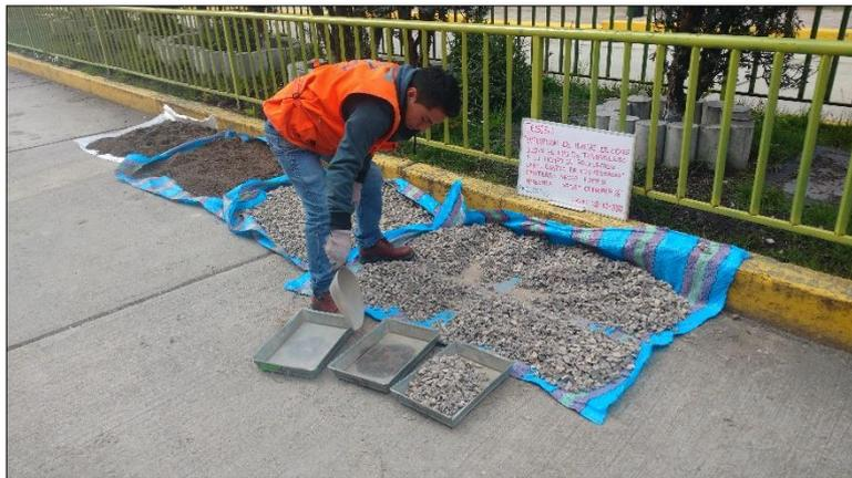
*Figura 17. Toma de muestras de Agregado Grueso (Cuarteo).*
