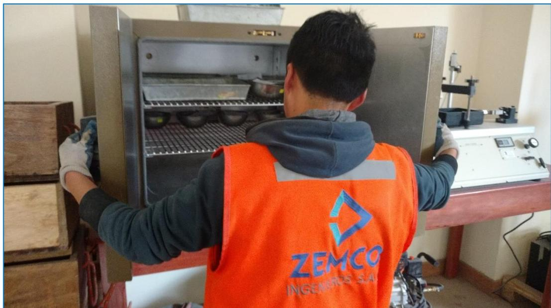
*En la vista, se desarrolla el ensayo para la determinación del contenido de humedad de los agregados (w%).*
