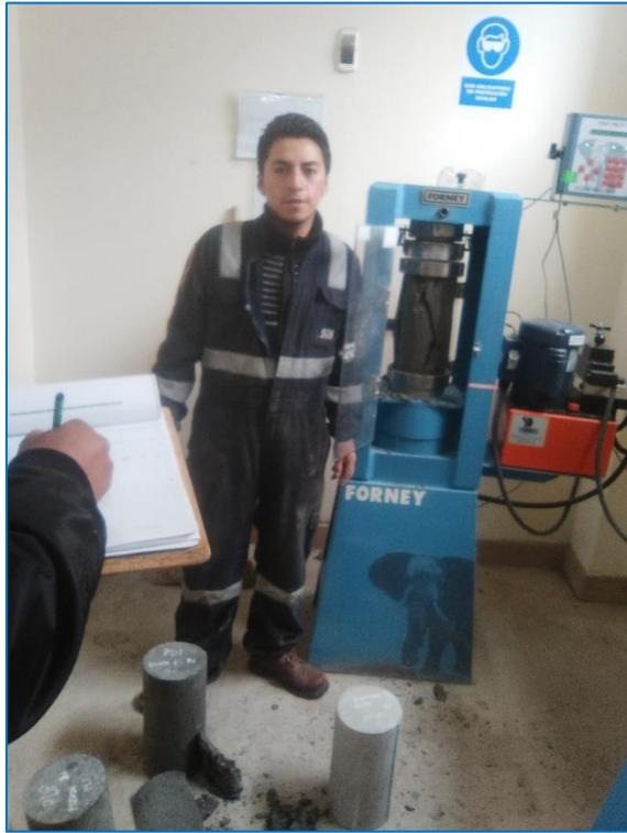
*En la vista, se desarrolla el ensayo de compresión axial de las probetas cilíndricas.*
