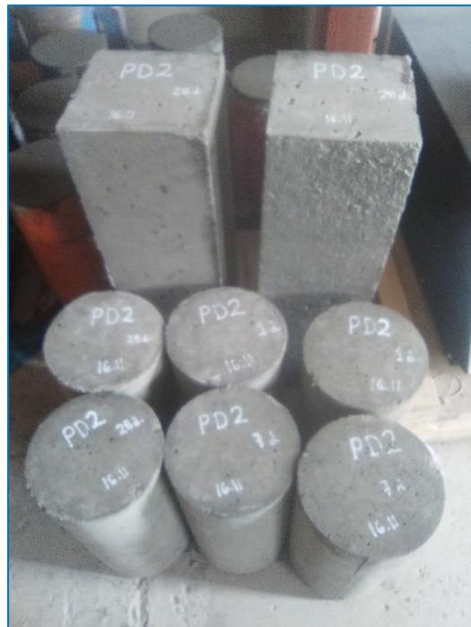
*En la vista, se presentan las probetas cilíndricas de 6"x12" y vigas, listas para ser curadas en la poza.*
