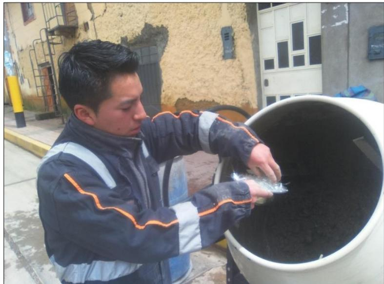
**Figura 20.** Adición de la Fibra de Polietileno a la mezcladora.
