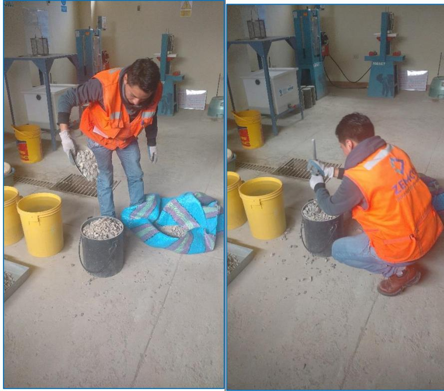
*En la vista, se realiza los ensayos para la determinación del Peso Unitario Suelto (ASTM C29) y Compactado (ASTM C29) del agregado grueso.*
