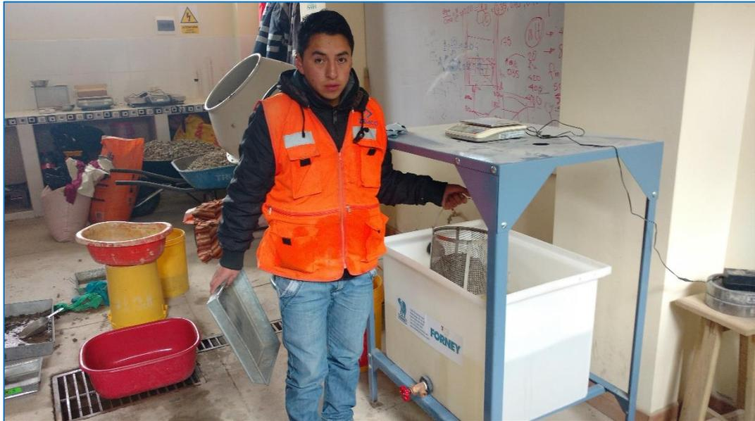
*En la vista, se practica el ensayo para la determinación del peso específico del agregado grueso (ASTM C131).*
