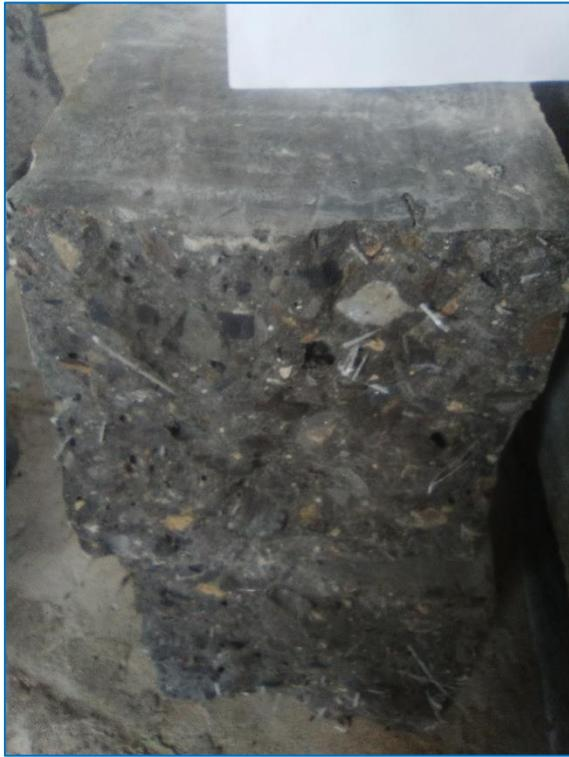
*En la vista, se observa las fibras de polietileno añadidas al concreto en las vigas ensayadas a flexión.*
