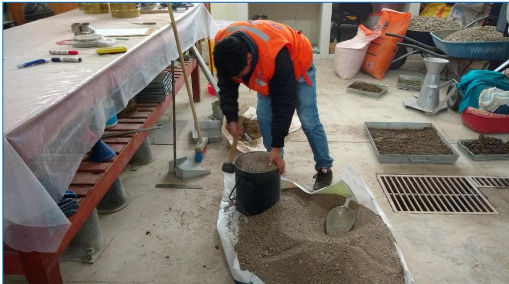
*En la vista, se procede con el ensayo para la determinación del Peso Unitario Suelto y Compactado del agregado fino.*
