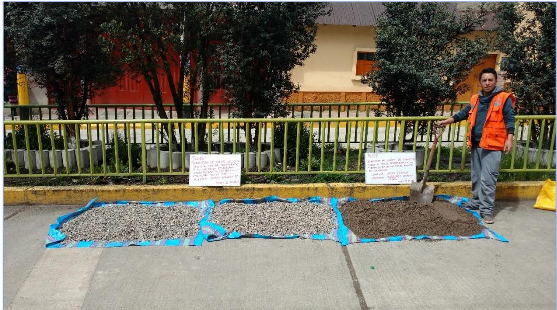
*En la vista, se aprecian las muestras de Agregado Grueso (Izquierda) y Agregado Fino (Derecha) para la determinación de sus propiedades.*
