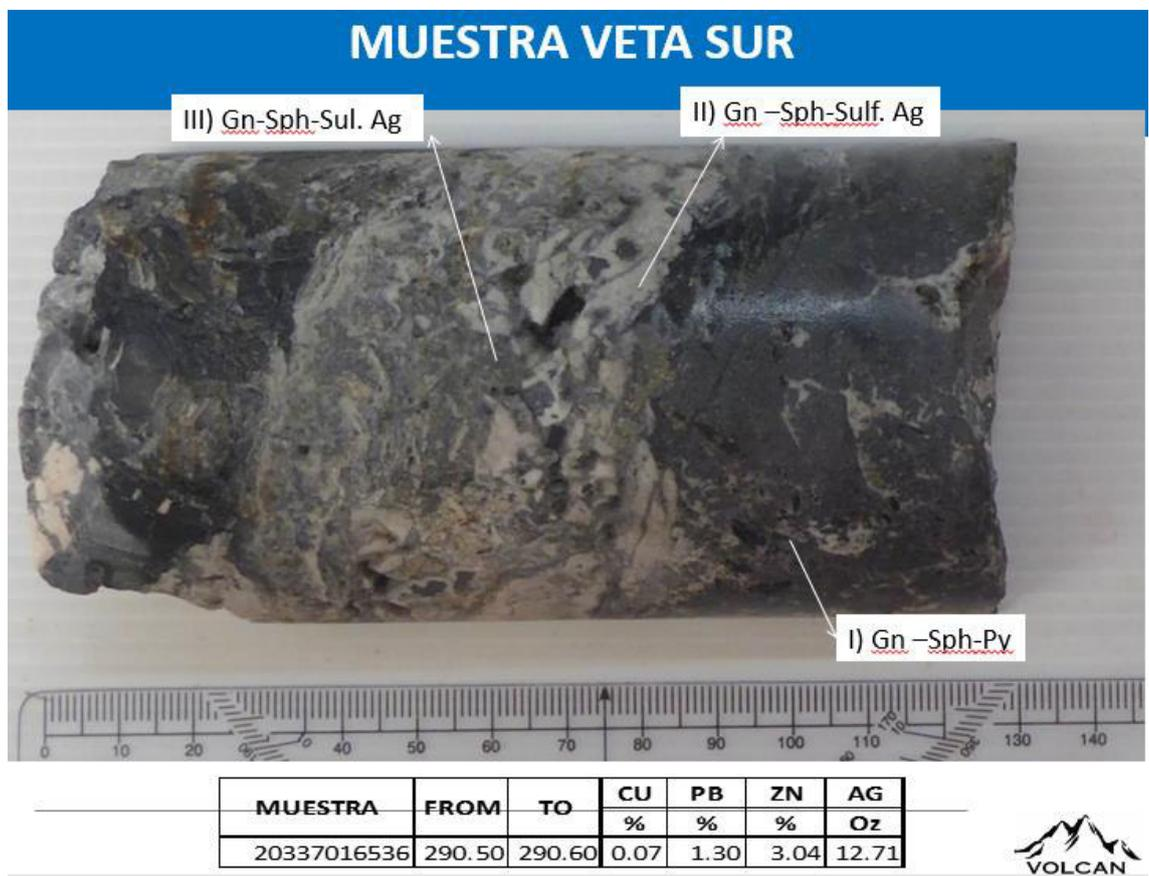
Figura IV.17: Muestra de sondaje de Veta Sur, con presencia de galena, esfalerita, platas rojas, calcita y rodocrosita.
